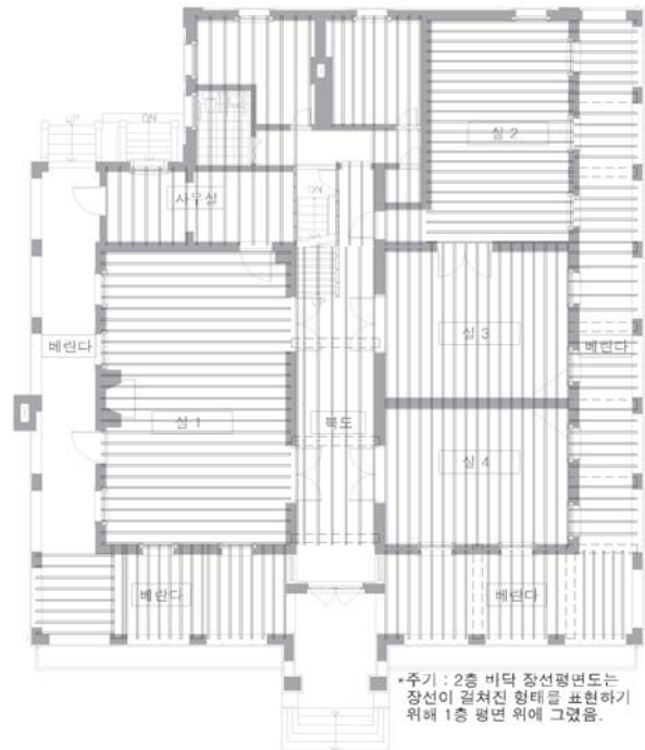
[도면 4-4] 2층 바닥 장선설치 평면도
