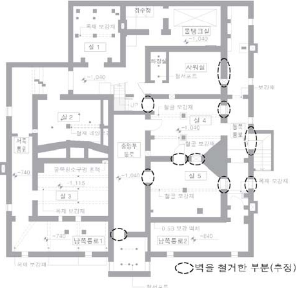
[도면 3-12] 지하 1층 기존벽을 철거한 부분
