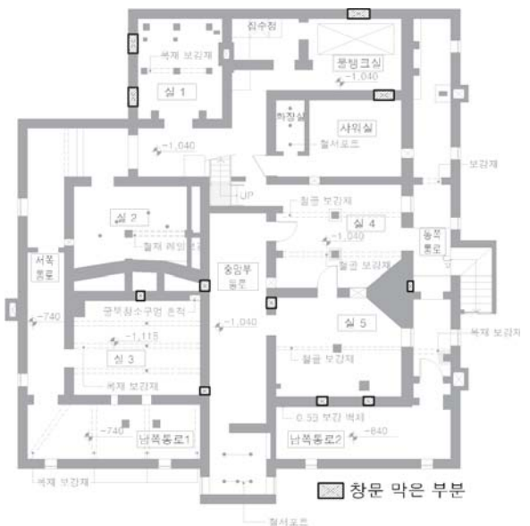
[도면 3-11] 지하 1층 창문을 막은 부분
