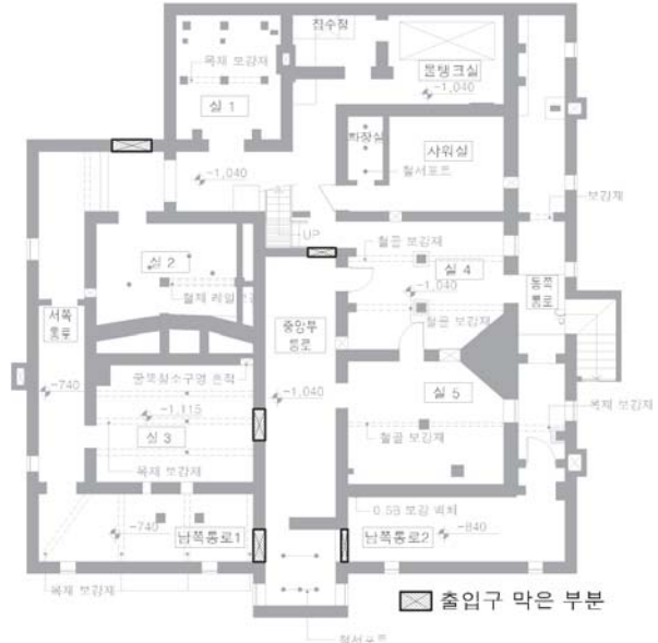
[도면 3-10] 지하 1층 출입구를 막은 부분
